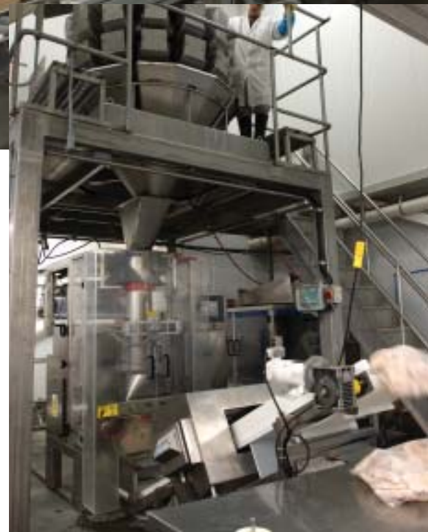
Vue d'ensemble de l'ensacheuse et de son système de pesée.
