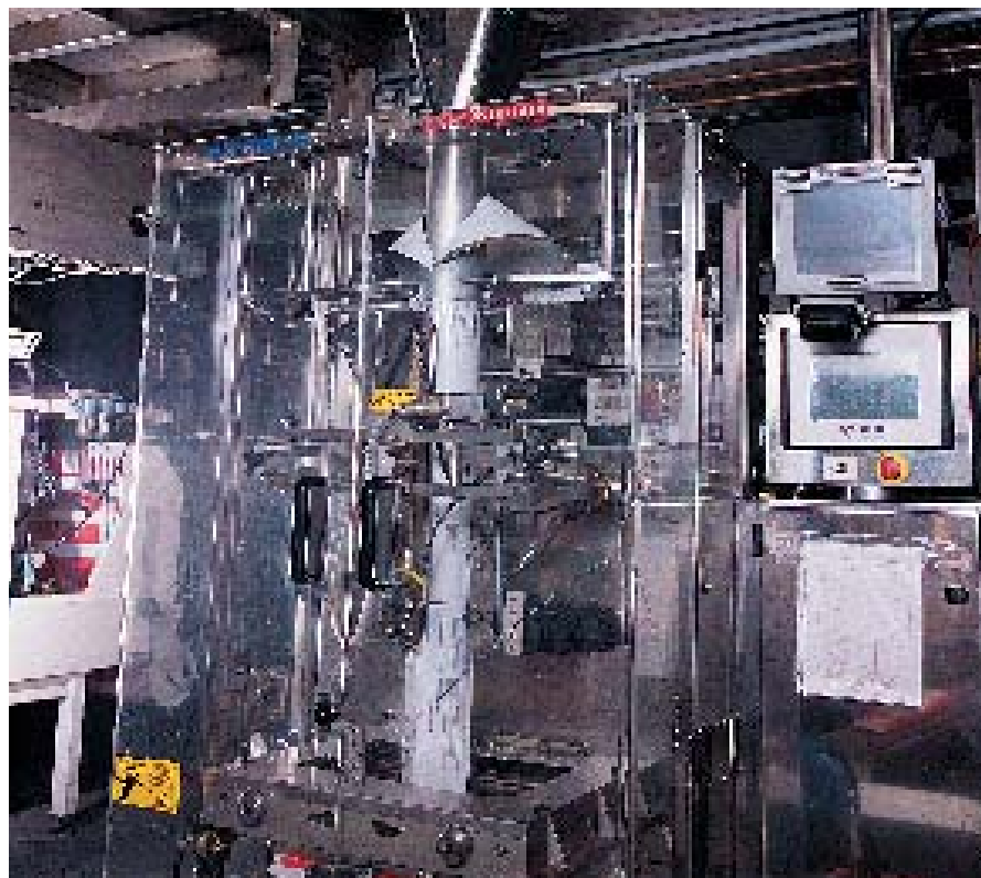
Les frites sont acheminées vers une formuse-remplisseuse-scelleuse verticale.
